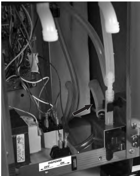
FIG 3 Initial Fill Hose - JDF-2S
